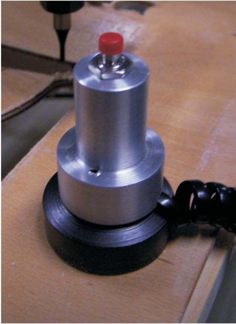
Snímač Z je mechanický nebo elektronický nebo optický senzor, který má stanovenou přesnou délku při sepnutí. Toho se pak využívá při najetí na materiál (obrobek), druhým způsobem najetí na materiál je ručně dle oka.
